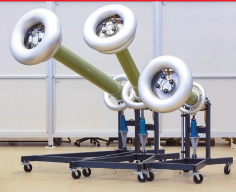
Abb. 3 Wassergefüllte Prüfendverschlüsse, Typ CET, verschiedene Nennspannungen
