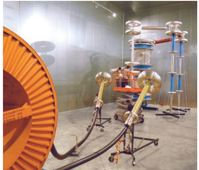
Abb. 5 Wassergefüllte Prüfendverschlüsse, genutzt für eine Wechselfspannungs-Routineprüfung an einem Hochspannungskabel
