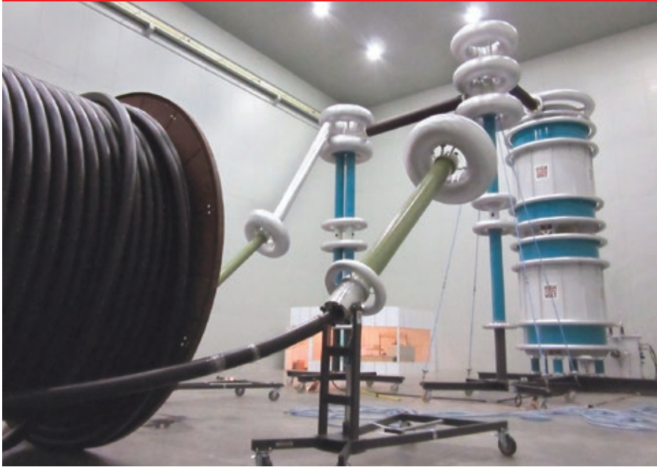
Abb. 1 Wassergefüllte Prüfendverschlüsse, Typ CET
